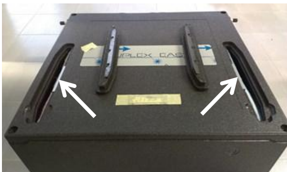
Riposizionare il coperchio, inserire le staffe metalliche di bloccaggio e reinserire i filtri dell'aria.
